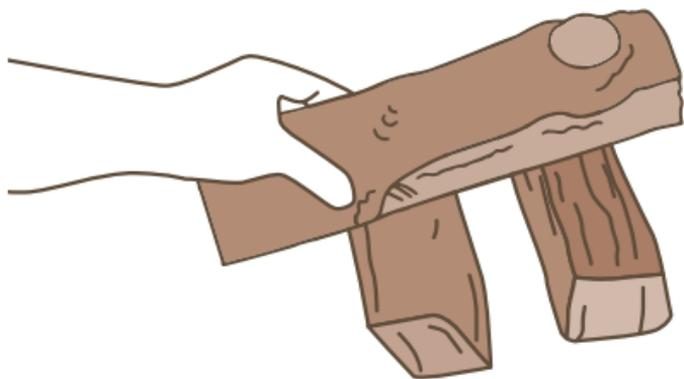
Hochwertiges, trockenes Stückholz oder Holzbriketts locker in den Brennraum schichten.
