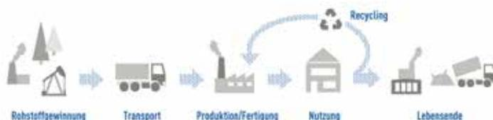
Abb.: Zur ökologischen Beurteilung eines Baustoffes ist es wichtig den gesamten Kreislauf von der Rohstoffgewinnung über die Herstellung bis zur Wiederverwendung bzw. Entsorgung zu berücksichtigen.
